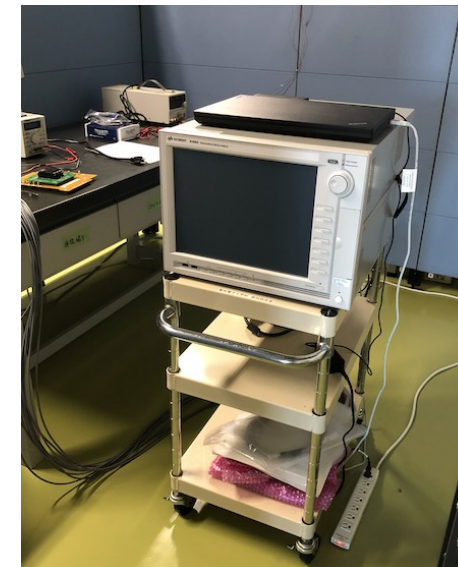
回路評価用測定器 (半導体パラメータアナライザ)
